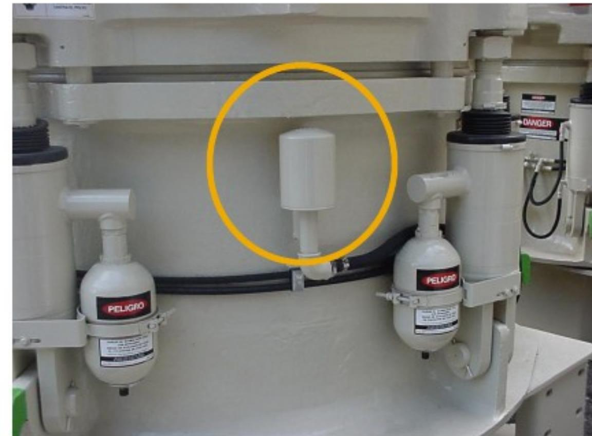
干净的水平轴呼吸器和油箱呼吸器让破碎机和油箱保持与大气相同的压力，保证破碎机的正常呼吸。这些呼吸器应至少每星期清理一次
