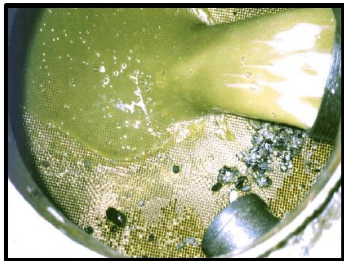
每日检查油箱滤网上的杂质有助于预报即将发生的故障。该滤网应始终保持干净清洁
