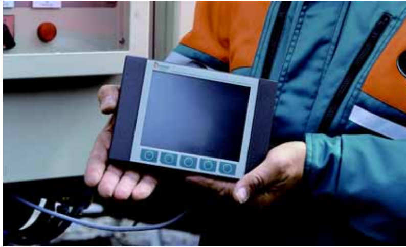
安装在 GP 圆锥破碎机的诺德伯格 IC50 自动控制装置
