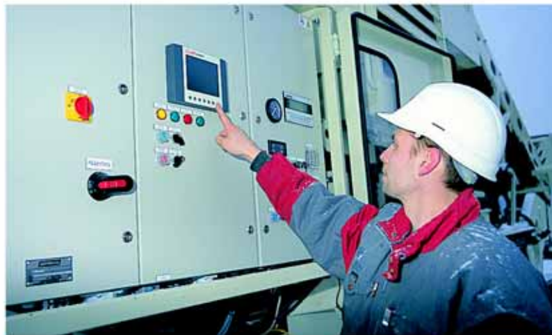
安装在诺德伯格 LT 移动破碎站 IC 自动控制装置
