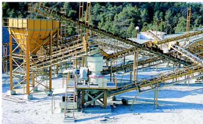
诺德伯格 GP11 圆锥破碎机用于固定式破碎站
